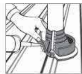
4. Vigye fel a tömítőanyagot, és a Dektite-et formálja rá a tetőlemezre.
