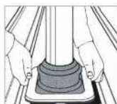
2. Illessze és jelölje a Dektite-t a profillemmezen.
