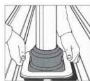
2. Illessze és jelölje a Dektite-ot a profilmezén.
