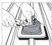
1. Illessze a Dektite-t a csőhöz.
