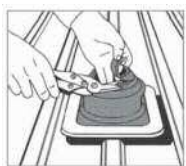
1. Illessze a Dektite-ot a csőhöz.
