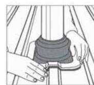
4. A Dektite-ot pontosan formálja rá a profilmezére.
