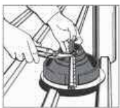
1. Illessze a Dektite-et a csőhöz.
