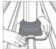
3. A Dektite illessze rá a tetőprofilra.
