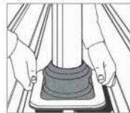
2. Illessze és jelölje a Dektite-et a profilmezemen.
