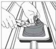
1. Illessze a Dektite-et a csőhöz.
