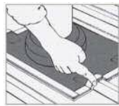
2. Illessze és jelölje a Dektite-ot a profilmezén.
