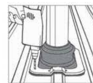
5. Rögzítse a Dektite-ot önfúró csavarral vagy Bulb-tite szegeccsel
