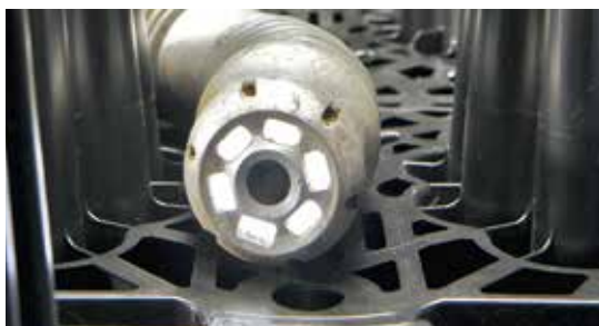
Kamera és nagynyomású mosófej bevezetése
